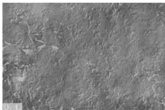
Abb. 8. Oberflächenabdruck von Attischem Terrakott-Rot (oben) und Schwarz (unten). Vergrößerung: 15000-fach. (Arch.-Nr. 1120/61, 1148/61).
